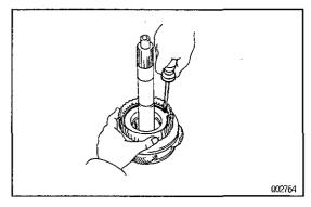
9. REMOVE ONE—WAY CLUTCH FROM OVERDRIVE PLANETARY GEAR
