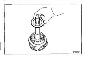
(d) Install the No.4 thrust washer.
