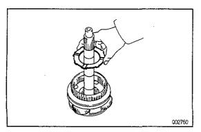
(d) Remove the No.3 thrust washer.
