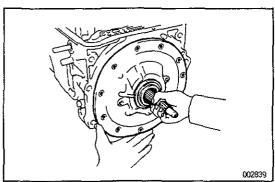
(d) Remove the oil pump and gasket.
