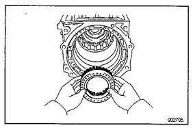
(d) Place the return spring on the brake piston.
