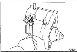
(d) Connect the lead wire to terminal C, and install the nut.
