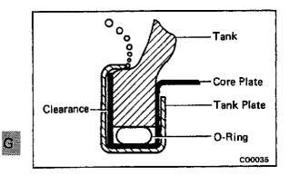
(d) Check for water leaks.
