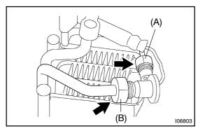
(d) Loosen the 2 nuts and remove the expansion valve.
