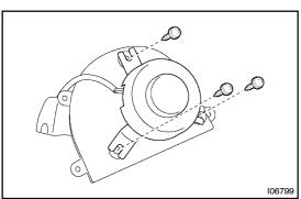
(d) Remove the 3 screws and motor.
