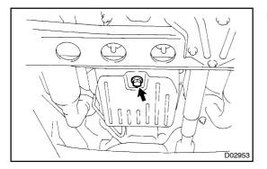
3. REMOVE DRAIN PLUG WITH GASKET AND DRAIN ATF
