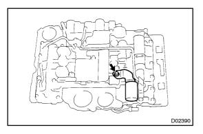
(d) Remove the bolt and solenoid valve.
