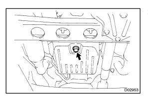
2. REMOVE DRAIN PLUG WITH GASKET AND DRAIN **ATF**
