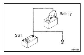
(d) Check functioning of the SST. SST 09082-00700
