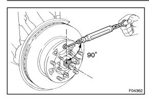
(d) Using a spring tension gauge, check the preload.
