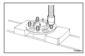
(d) Using a press, remove the hub bolt.
