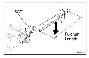
(d) Using SST, torque the stopper.
