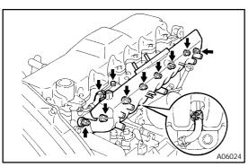
17. INSTALL INTAKE MANIFOLD
