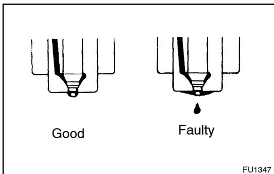
**2. LEAKAGE TEST**
