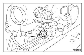
(d) Disconnect ISC valve connector
