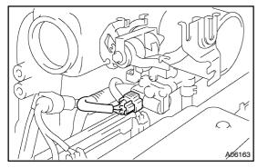
(d) Disconnect ISC valve connector
