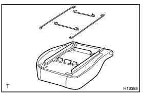
(d) Disconnect the 4 seat wires.
