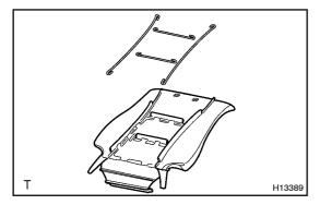
(d) Disconnect the 4 seat wires.
