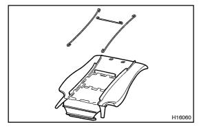
(d) Disconnect the 3 seat wires.
