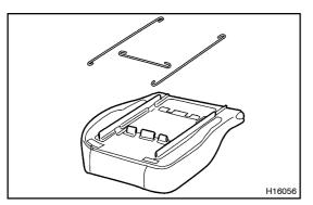
(d) Disconnect the 3 seat wires.
