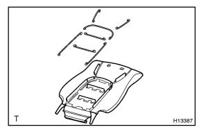
(d) Disconnect the 7 seat wires.
