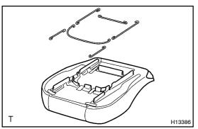
(d) Disconnect the 6 seat wires.
