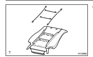
(d) Disconnect the seat wires.
