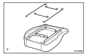
(d) Disconnect the seat wires.
