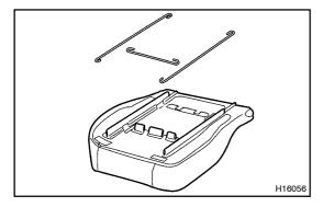
(d) Disconnect the 3 seat wires.
