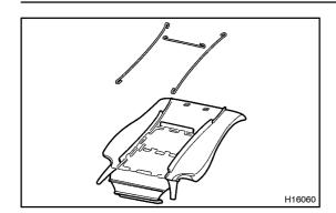
(d) Disconnect the 3 seat wires.
