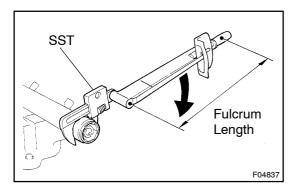
(d) Using SST, torque the stopper. SST 09922 –10010
